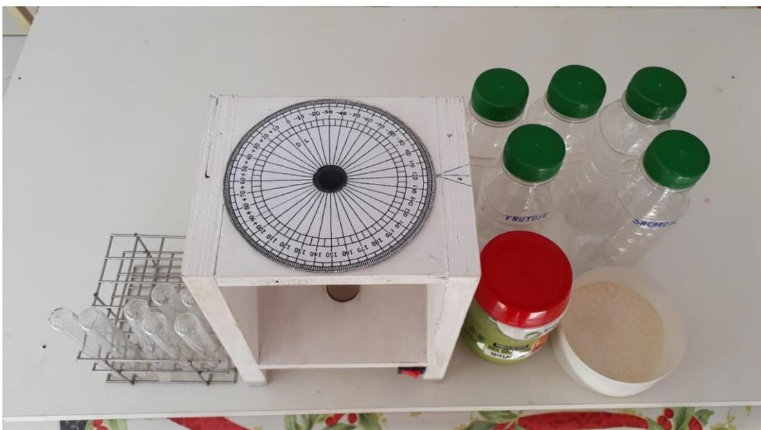
Figura 24. Polarímetro pronto.
