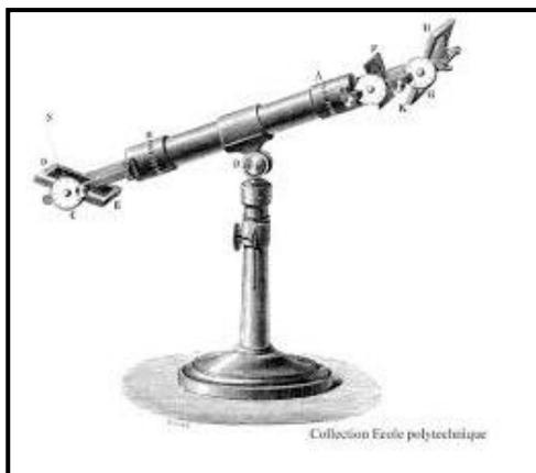
Figura 9 Polarímetro De Biot
