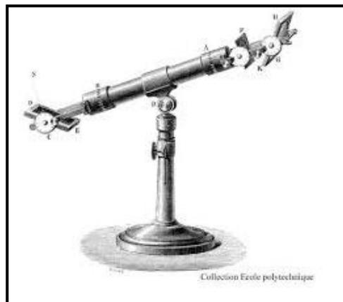
Figura 9: Polarímetro De Biot
