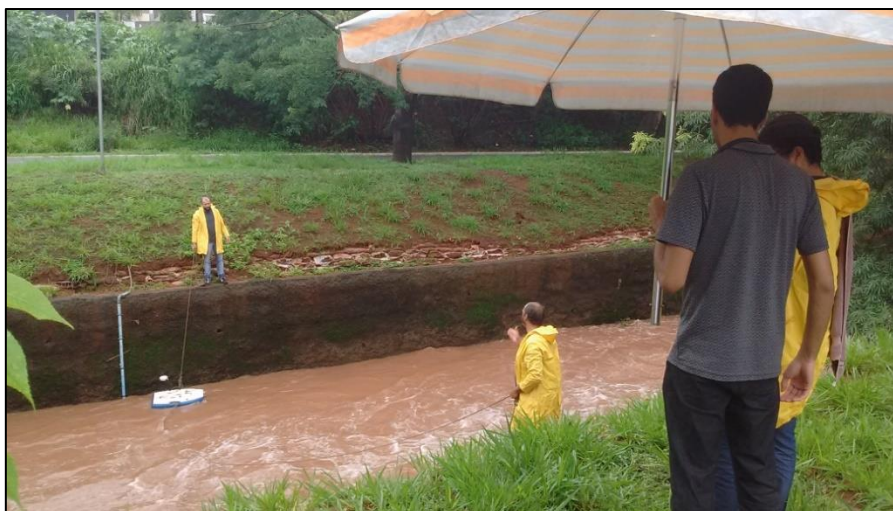
Figura 6 - Levantamento de curva chave para a seção exutório, com auxílio de sensor ADCP. Nota-se a presença do sensor de nível e do poste que armazena o pluviômetro. Outubro de 2018. Dos autores.
