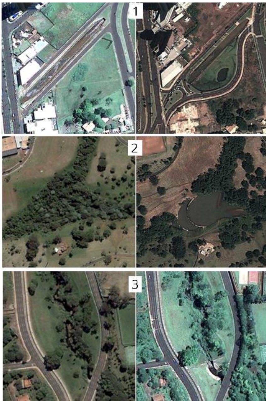
Figura 33 - Obras de proteção contra inundações implantadas em Campo Grande, na bacia do Prosa. Temos na figura 1 a construção do piscinão (imagem de 2009 a esquerda e 2013 a direita), 2 a escavação dos lagos de contenção (imagem de 2006 a esquerda e 2013 a direita) e no 3, a edificação das barragens (imagem de 2006 na esquerda e 2013 na direita). Imagens proprietárias do Google.
