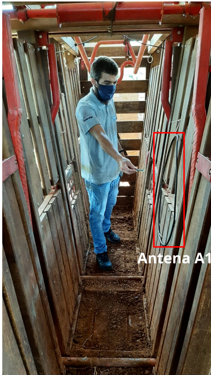
Figura 65: Interrupção do feixe infravermelho e aproximação manual do transponder a 10 cm da antena dentro do corredor do mangueiro digital.
