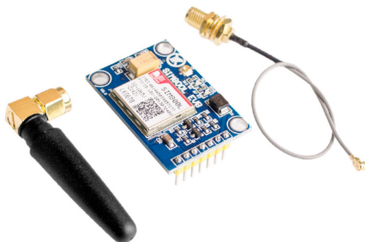
Figura 11: Módulo SIM800L EVB com a antena. Dimensões: 15,8 x 17,8 x 2,4 mm.
