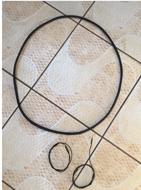
Figura 8: Antena RFID circular construída para utilização estacionária.
