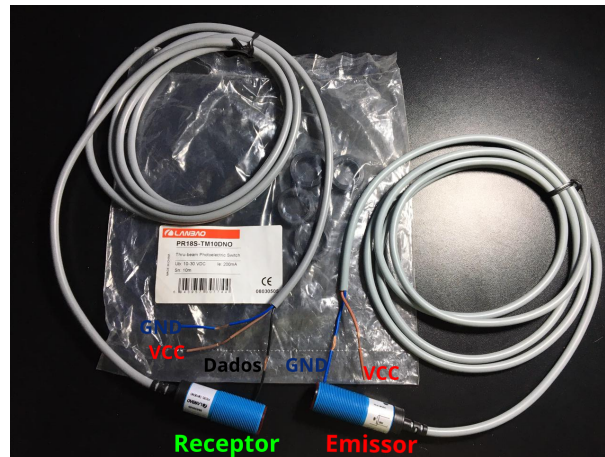
Figura 14: Sensor de proximidade PR18S-TM10DNO com indicação dos terminais.
