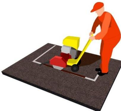
Figura 7 – Corte e remoção do revestimento asfáltico.
