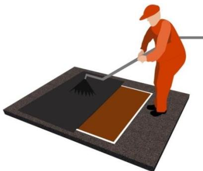
Figura 8 – Execução da pintura de ligação.
