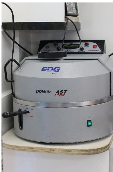
Figura 02 – Fundidora por indução eletromagnética
