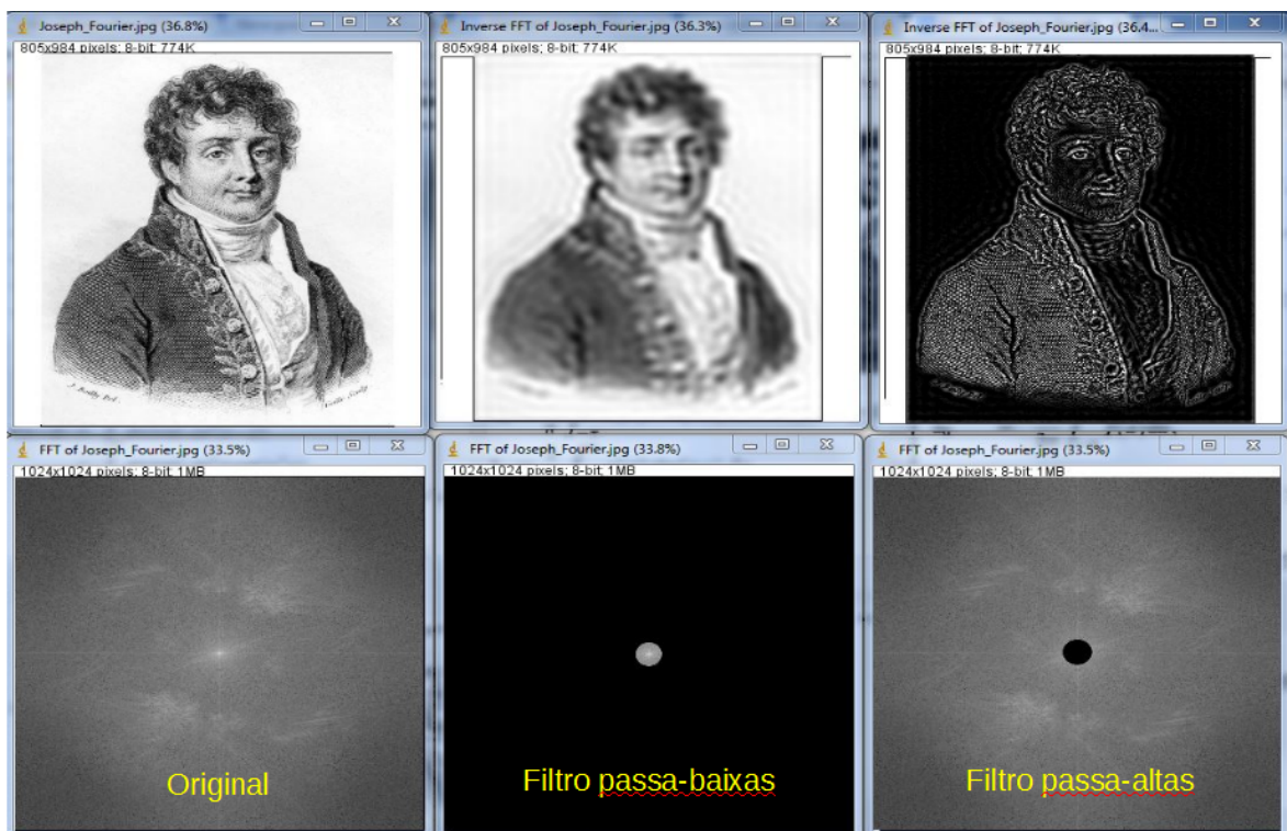
Figura 3.7: Exemplo de filtros passa-baixas e passa-altas.
