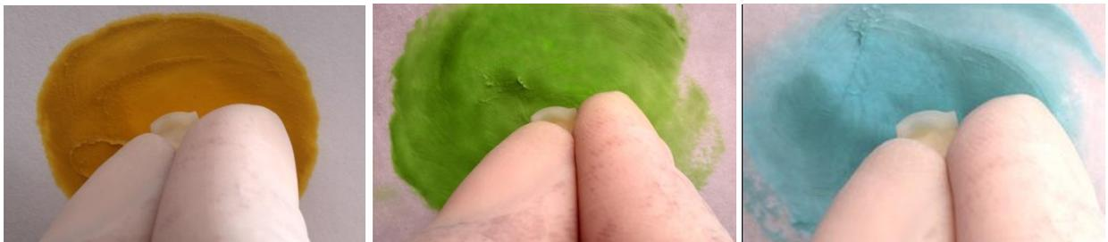
Figura 7 - Polimento da superfície do esmalte com pasta extrafina de  $6\mu\text{m}$ ,  $3\mu\text{m}$  e  $1\mu\text{m}$ .
