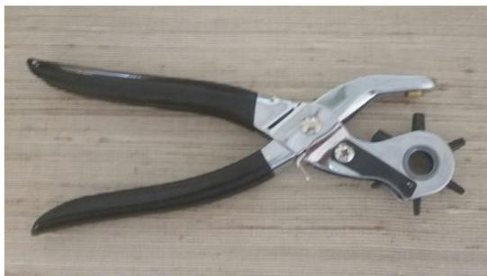
Figura 4.3 – Perfurador utilizado para confecção dos orifícios nas placas de acetato.
