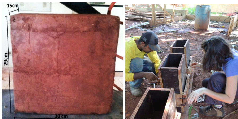
Figura 54: Corpo de prova moldado paralelamente à execução das paredes.
