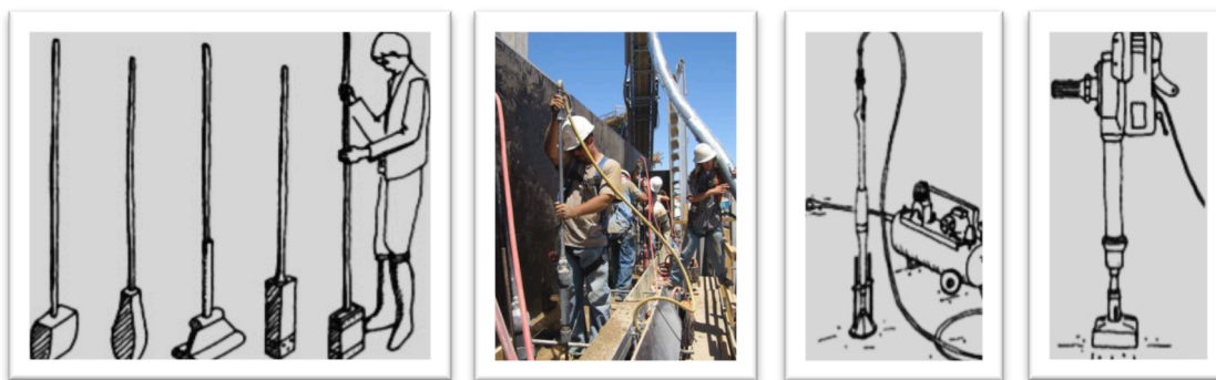
Figura 8: Tipos de compactadores: manuais, pneumáticos e mecânico
