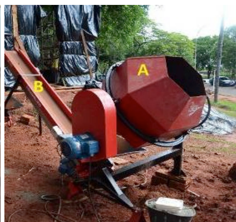
(b) Misturador hexagonal (A) + Esteiras (B)
