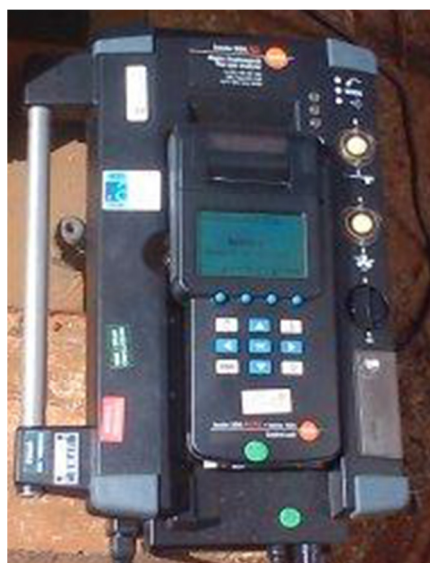
Figura 6 – Analisador de poluentes atmosféricos da Testo – 350 XL são fornecidas nas Tabelas 12 e 13.
