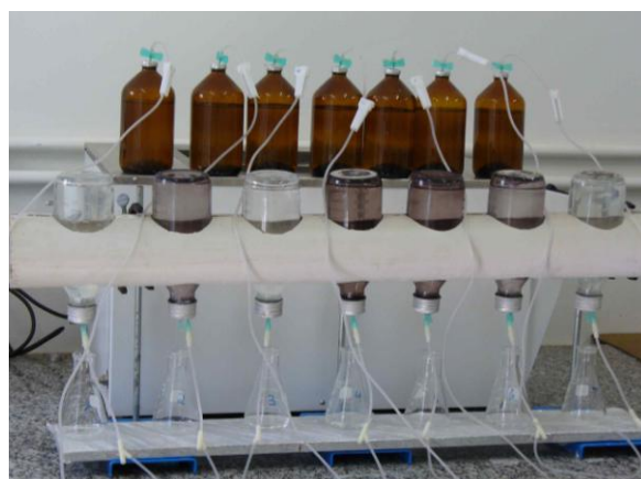
Figura 2.2. Medição de biogás no teste de biodegradabilidade.
