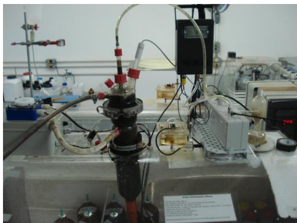
Figura 3.2. Reator UASB em escala de bancada, tratando vinhaça.
