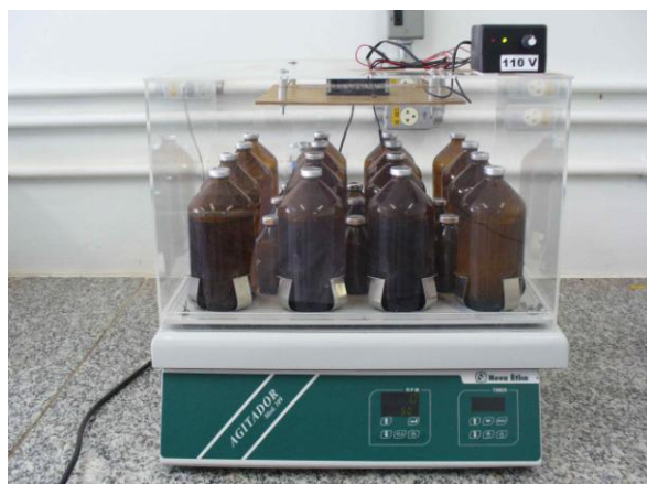
Figura 2.1. Agitador adaptado composto por cúpula de acrílico e termostato.
