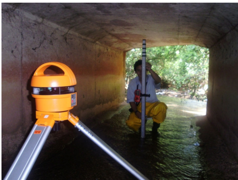
Figura 4.9: Medição da declividade do canal com nível a laser
