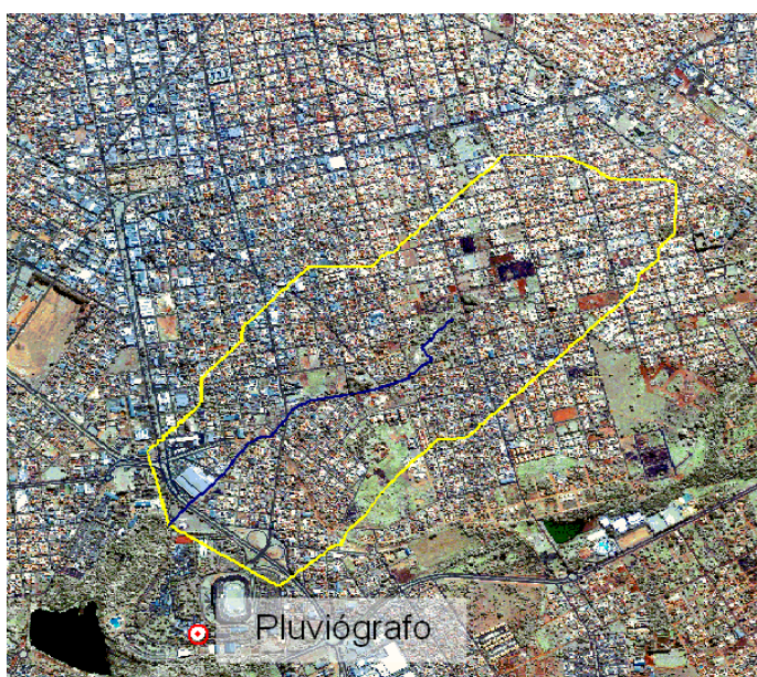
Figura 4.11: Posição do Pluviógrafo em relação à área de drenagem
