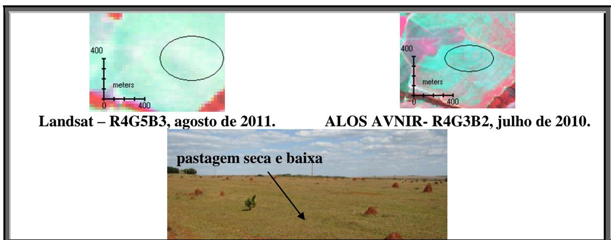
Figura 8. Exemplo de resposta espectral “Cel” no sensor Landsat e ALOS AVNIR, em campo está indicado pela seta, correspondendo à pastagem seca com vegetação baixa.
