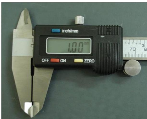
Figura 5 - Paquímetro Digital
