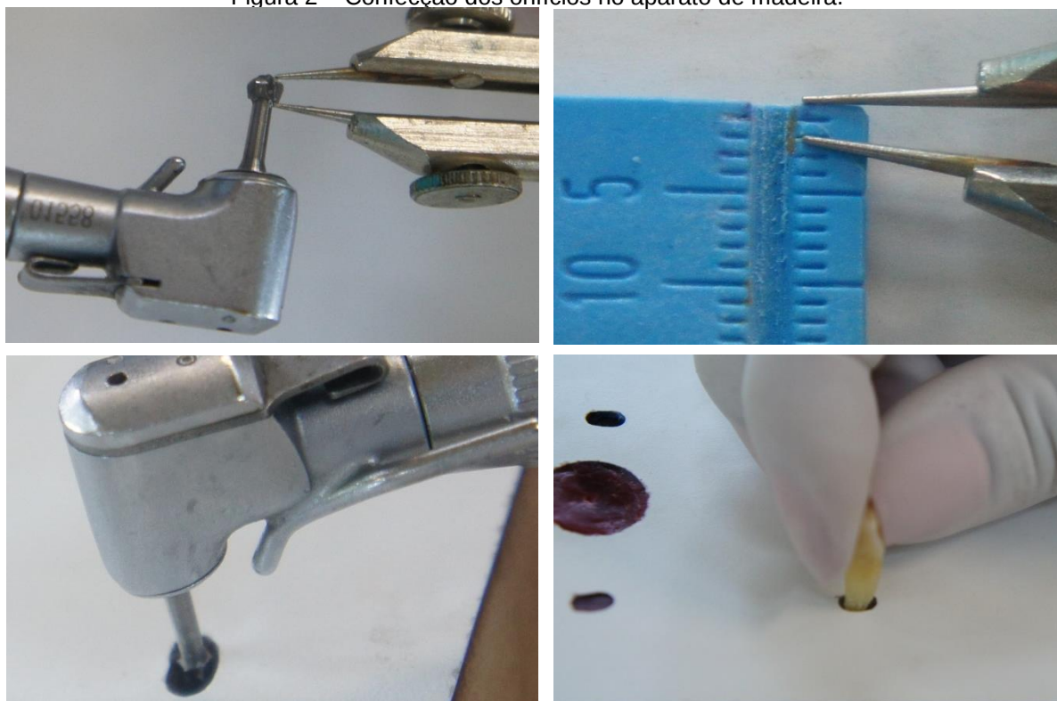
Figura 2 – Confeccção dos orifícios no aparato de madeira.
