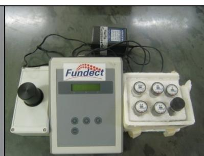
**Figura 15:** Tecnopon TB 1000, utilizado para medir a turbidez da água.
