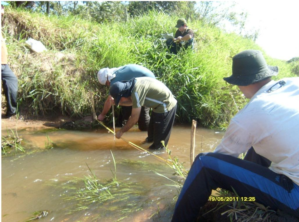
**Figura 21:** Mensuração do perfil transversal para a obtenção da área do canal.
