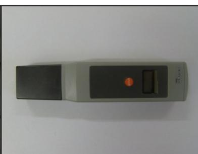
**Figura 14:** Phtek Cd-203, usado para medir a condutividade elétrica existente na água.
