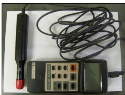
**Figura 13:** Lutron DO – 5510, utilizado para calcular o oxigênio dissolvido - OD na água e a temperatura do ar e da água.
