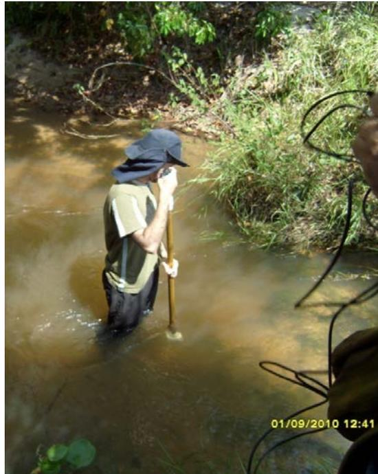
**Figura 20:** Mensuração da velocidade do fluxo do canal transversal
