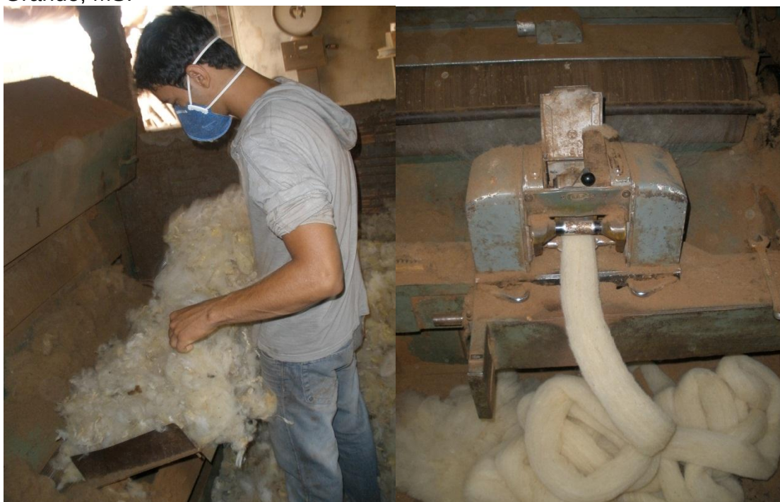
Figura 18 - Funcionário transferindo lã “rasgada” para a máquina de cardar (esquerda), lã em processo de carda (direita) – Lanifício Pantanal – Campo Grande, MS.
