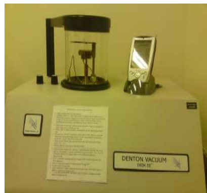
Figura 5 - Equipamento utilizado para deposição metálica sobre as amostras.
