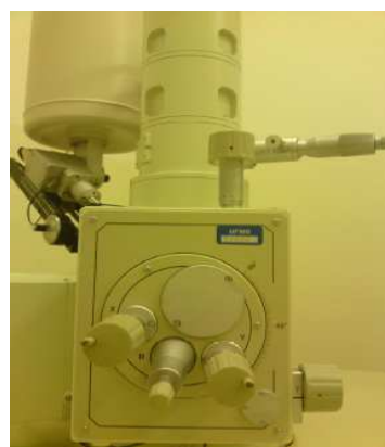
Figura 7 - Coluna ótico-eletrônica, detector e câmara de amostras.
