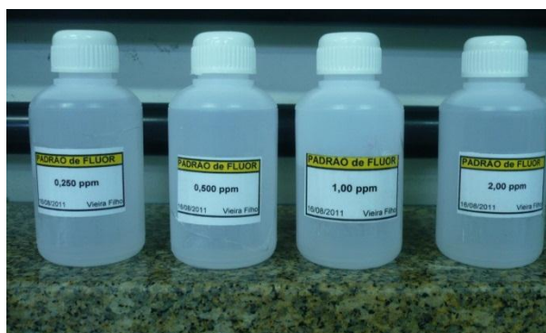
Figura 3 - Soluções padrão de flúor utilizadas na calibração do eletrodo.
