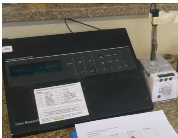
Figura 2 – Eletrodo específico Orion 96-09 acoplado ao analisador de íons Orion EA-940.
