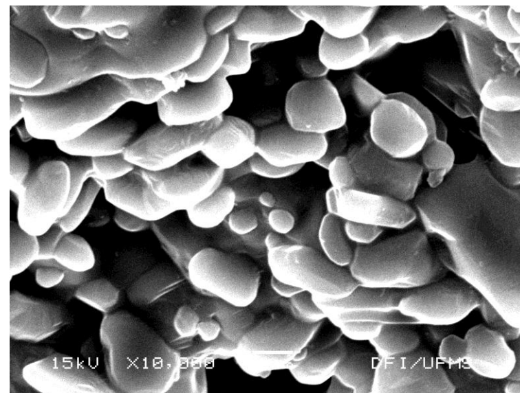
Figura 25 – Alumina 5% de silica sinterizada com laser CO 2 , lado (b)
