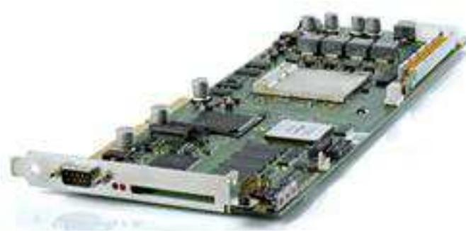
Figura 4.21 – Placa PCI de desenvolvimento (Dspace).
