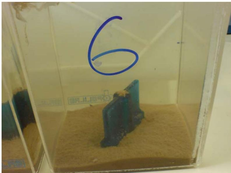
FIGURA 5.2. Efluente clarificado após o Ensaio Coagulação – Flocculação pelo Teste de Jarros.
