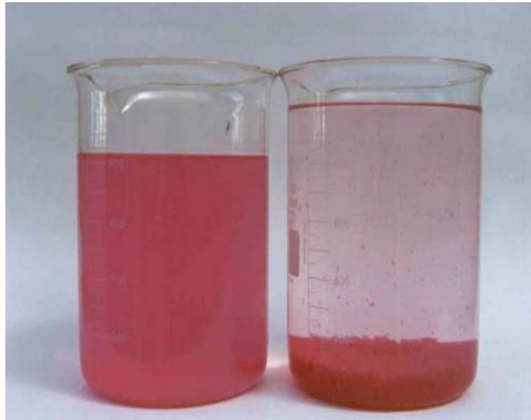
Figura 3.1 – Amostra de efluente de indústria de papel após ser tratado por meio do processo de coagulação/floculação.
