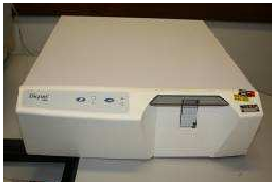
Figura 4 - Leitor a laser da placa de fósforo fotoativado Digora® (Soredex).
