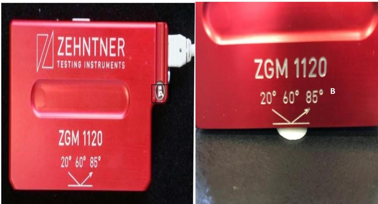
O princípio de mensuração do aparelho é baseado num feixe de luz que incide na superfície da amostra em ângulos de 20°, 60° e 85°. O aparelho mede a intensidade da luz refletida e compara com um valor de referência.
