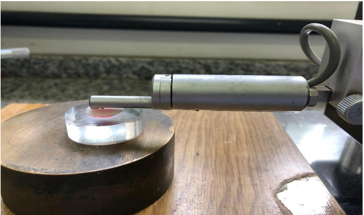
O parâmetro utilizado foi o Ra (média aritmética dos desvios de rugosidade do perfil). Cada corpo-de-prova foi submetido a três leituras no rugosímetro, em
