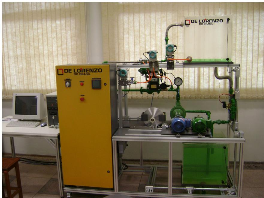
**Figura 4.7 – Estação de simulação da bomba centrífuga do LAMOTRIZ**
