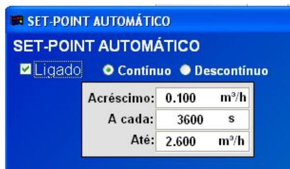
Figura 5.1 – Função de *set-point* automático no modo contínuo
