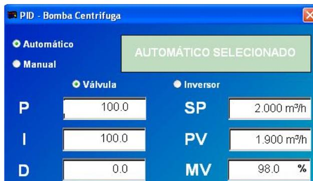
**Figura 4. 13 – Janela de controle PID da bancada da bomba com indicação do SP de vazão.**
