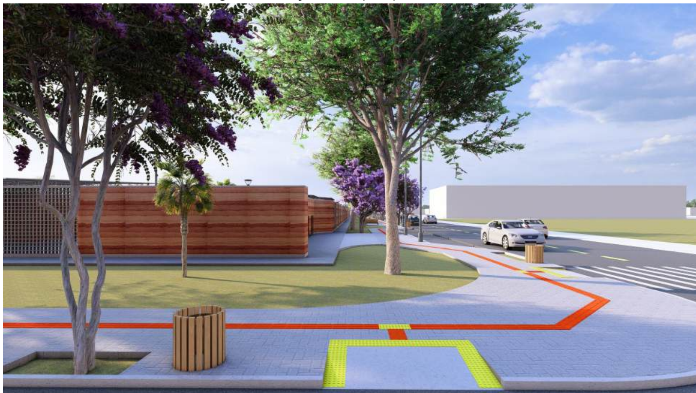
Figura 65. Calçada com piso podó tátil e mobiliário.
