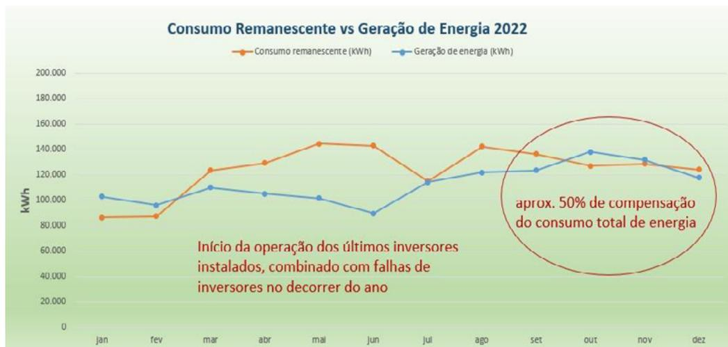
O Gráfico 3 ilustra a compensação do consumo total de energia em certas unidades (como a Reitoria) através dos sistemas fotovoltaicos na segunda aquisição.
