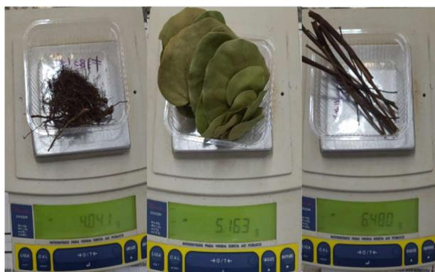
Figura 2: Determinação de massa seca de raiz, caule e folha por pesagem em balança de precisão.
