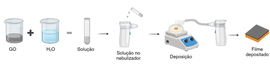
Figura 11 - Modelo esquemático da deposição de filmes finos através da técnica de deposição por nebulização. Fonte: própria autora.
