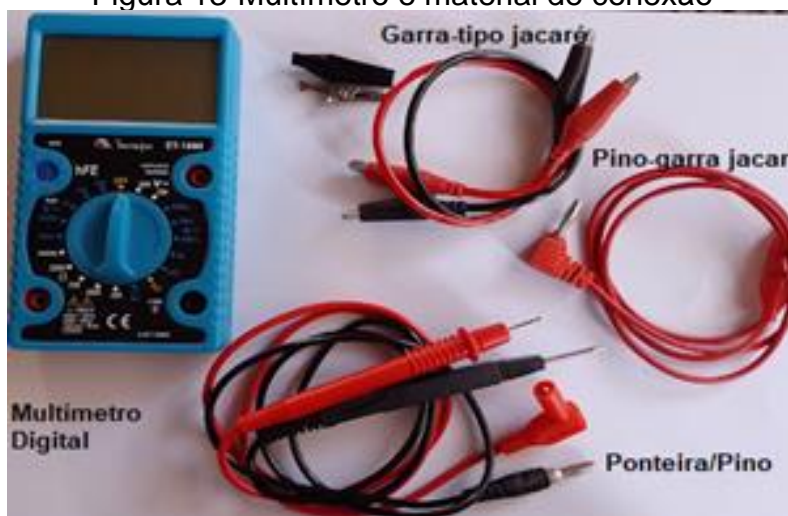
Figura 13-Multímetro e material de conexão
