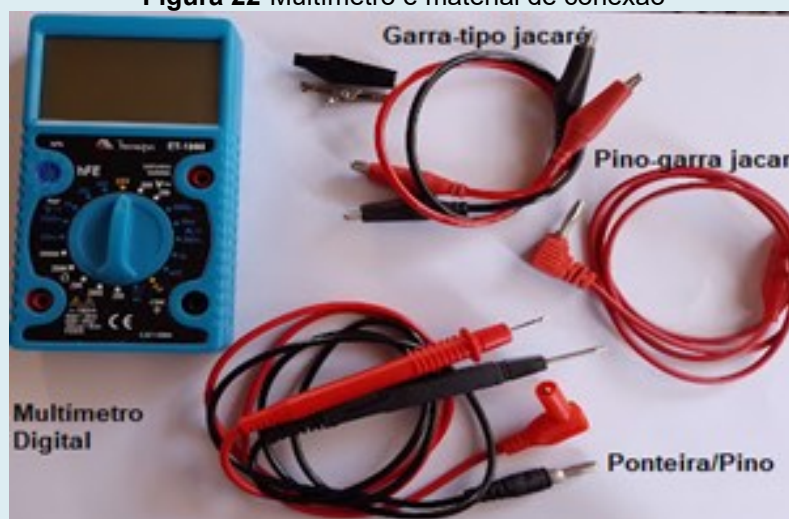
Figura 22- Multímetro e material de conexão
