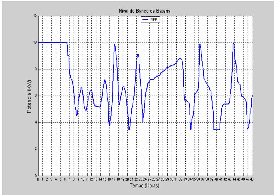
Figura 5.31 - Nível do banco de baterias (48 horas).
