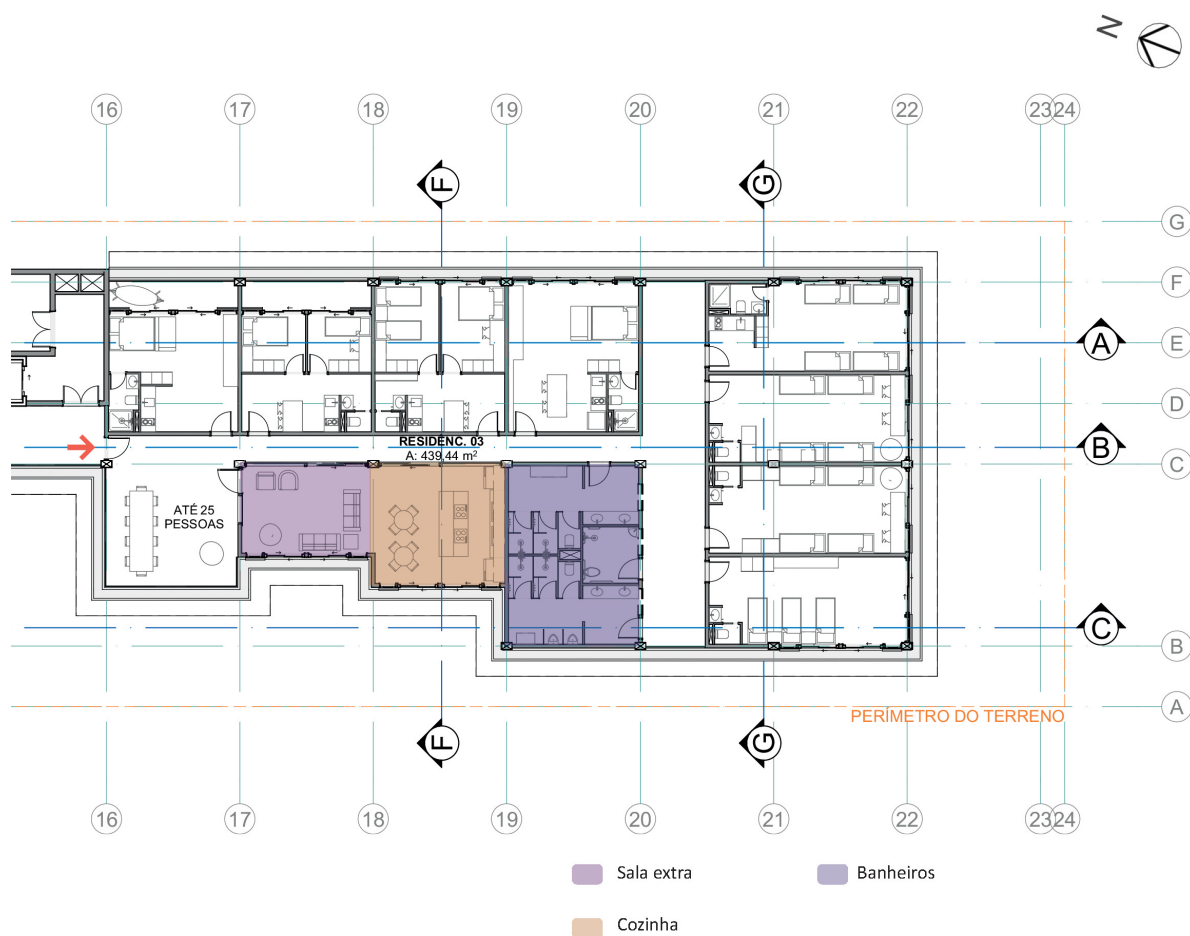
Figura 52 - Planta de setorização dos módulos de descanso, alimento e higiene da Residência 03.
