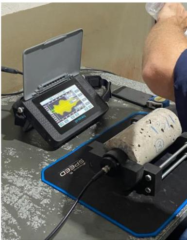
Através dos pulsos ultrassônicos, é possível obter parâmetros como a velocidade e tempo de propagação das ondas. A resistência do concreto, é obtida empiricamente por meio de uma curva pré-definida pelo aparelho conforme Pereira e Formagini (2022). Além disso, é possível determinar o módulo de elasticidade estático empiricamente, através de leituras das propagações das ondas e análises gráficas realizadas diretamente no aparelho.
