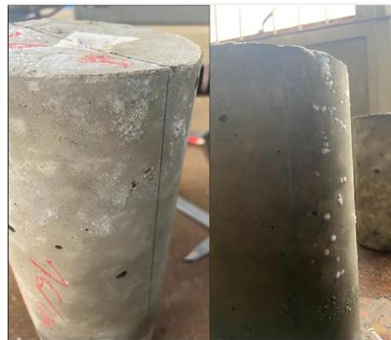
As concentrações mais significativas foram observadas nos corpos de prova com adição de óxido de grafeno em 0,06% aos 28 dias. Essa maior ocorrência de precipitação de carbonato de cálcio pode ser atribuída à interação entre os componentes do concreto e o óxido de grafeno adicionado.
