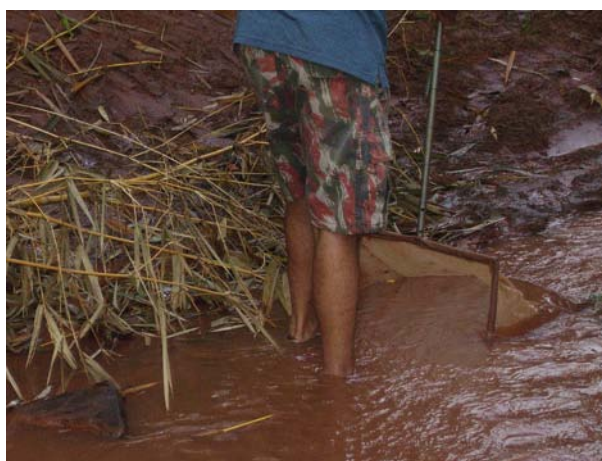
Figura 4.1 – Coleta pelo método de Kicking Sampling .
