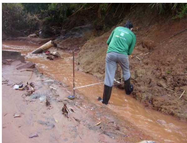
Figura 2.1 – Metodologia de medidas hidrológicas, utilizando molinete hidrológico.
