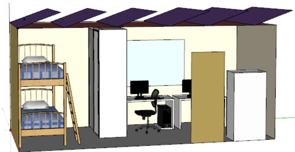
Figura 16 – Contêiner utilizado para fins militar em campanha em módulo dual com placa solar
