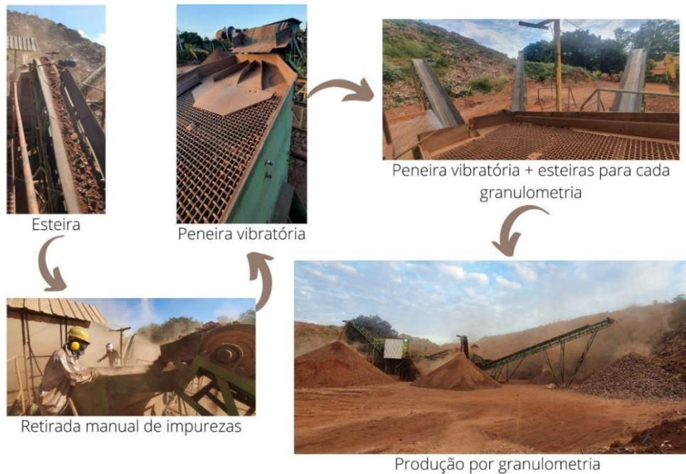
Figura 31 - Processo de reciclagem do RCC após a britagem
