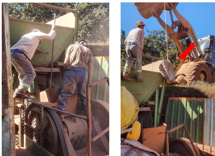
Figura 33 - Desobstrução do britador
