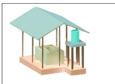
Figura 1 Esboço no AutoCAD do resfriador evaporativo
