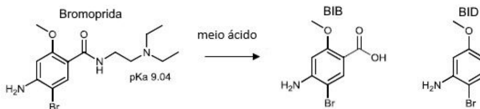
Figura 23 Bromoprida e seus produtos de degradação BIB e BID obtido pela quebra da ligação carboxílica do grupo amida na degradação ácida realizada.
