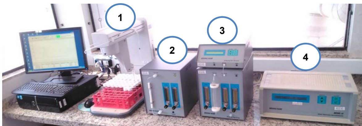
Figura 25. Espectrômetro de Fluorescência Atômica, MERX da BrooksRand. 1 (amostrador automático); 2 (módulo mercúrio total); 3 (módulo para especiação de mercúrio); 4 (detector por CV-AFS).
