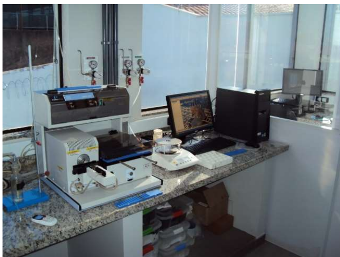
Figura 24. Espectrômetro de absorção atômica dedicado para quantificação de mercúrio em amostras sólidas – equipamento SMS 100 da Perkin Elmer
