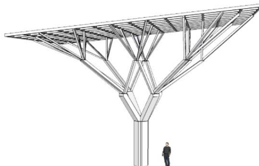
Modulo do pilar com 10% de inclinação
