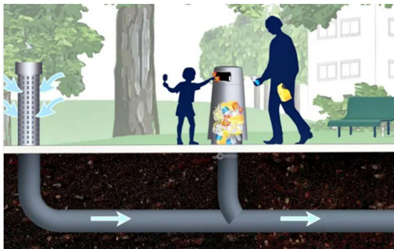
Figura 4: Sistema de coleta a vácuo em Barcelona
