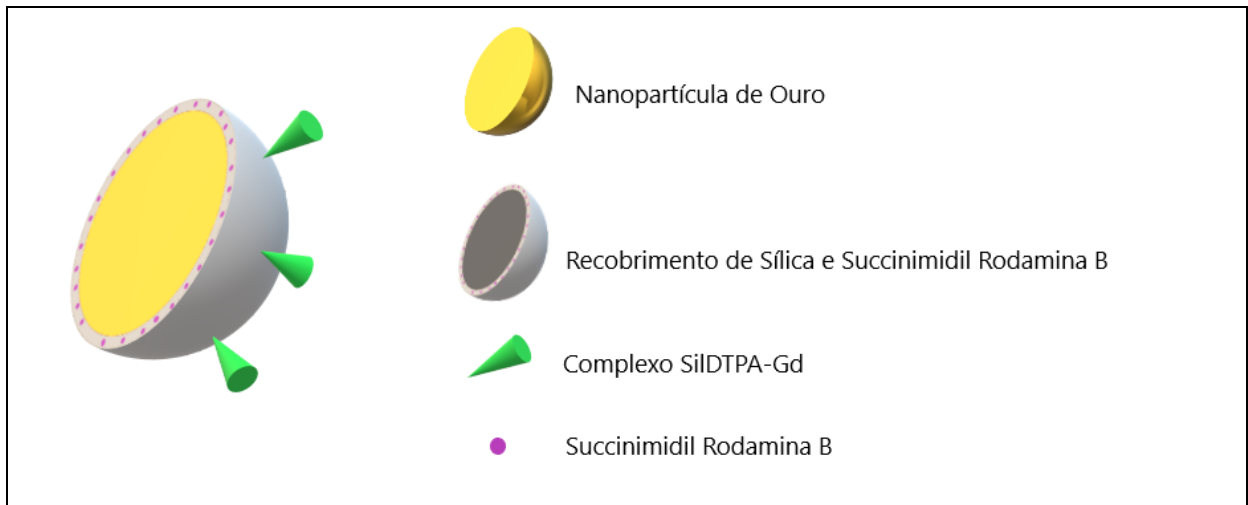
Figura 9 - Representação Esquemática da Síntese
