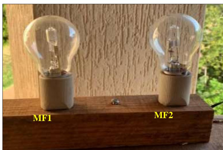
**Figura 15** - Lâmpadas de 60 W alimentadas pelos MFs.
