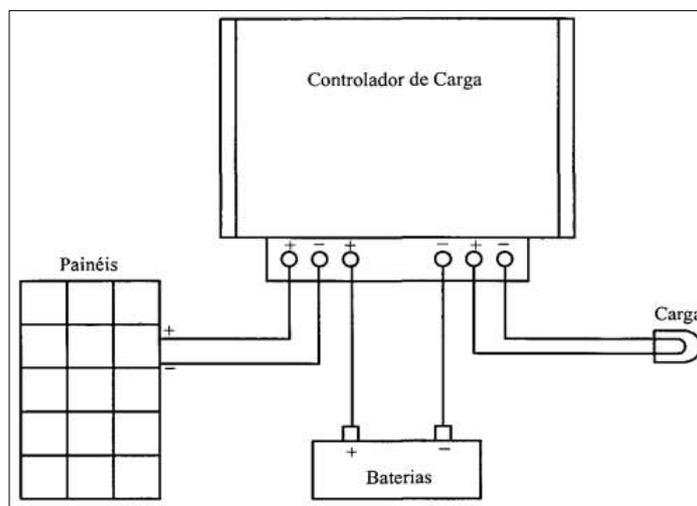
**Figura 8** - Esquema de ligação do controlador de cargas
