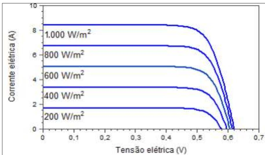
**Figura 11** - Influência da irradiação solar em célula fotovoltaica de silício
