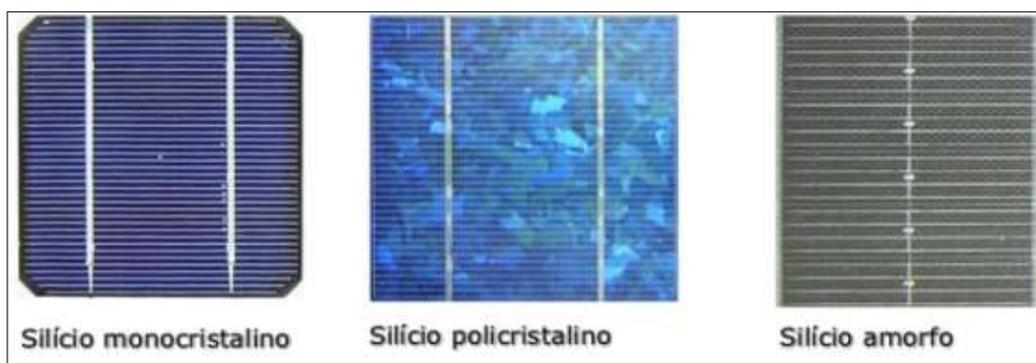
**Figura 3** - Tipos de células fotovoltaicas comerciais
