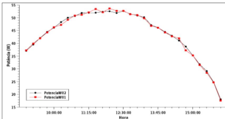
**Figura 23** – Gráfico de potência de saída dos módulos em condições idênticas.
