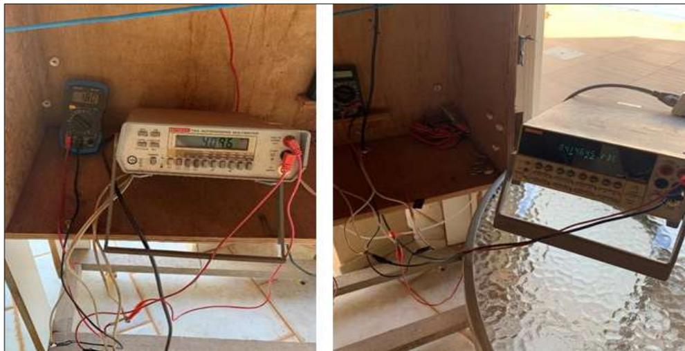
**Figura 21** – Arranjo dos multímetros para medições.
