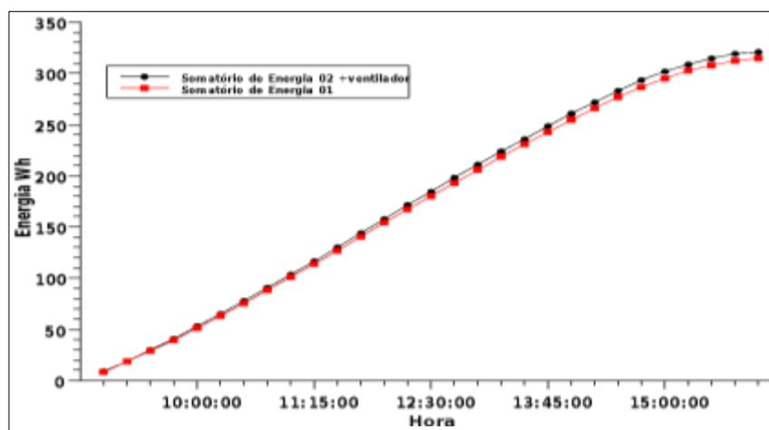
**Figura 26** – Somatório das energias geradas pelos MFs ao longo do dia
