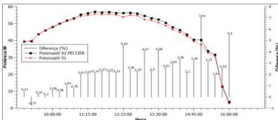
Figura 29 – Potência comparativa do MF resfriado com Peltier.
