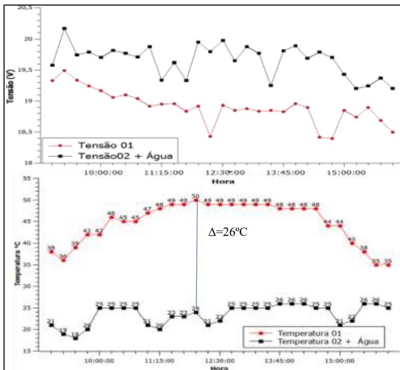
**Figura 33** – Temperatura e tensão do MF com a água.
