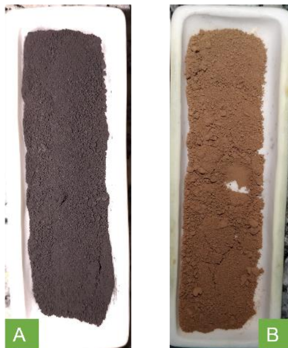
Figura 26 -A) Bagaço de cana moído e peneirado (amostra BCC); B) Bagaço de cana moído e peneirado, após procedimento de calcinação com circulação de ar contínua (amostra CBCC).
