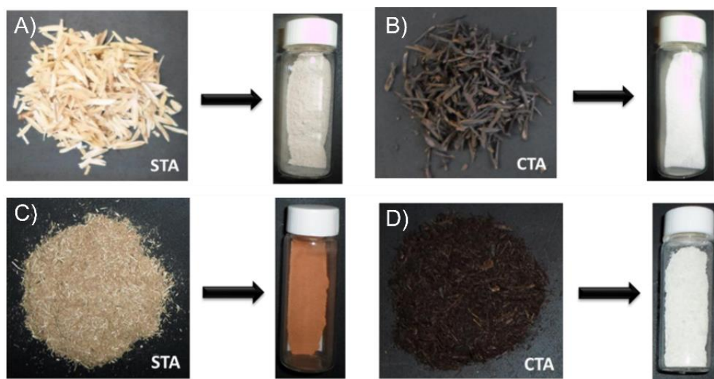
Figura 6 – Sílica biogênica obtida por Oliveira [15]. A) Cascas de arroz e respectiva sílica obtida por calcinação direta; B) Cascas de arroz lixiviadas e a sílica obtida pós calcinação destas cascas; C) Bagaço de cana de açúcar e respectiva sílica obtida por calcinação direta; D) Bagaço de cana lixiviadas e a sílica obtida pós calcinação deste bagaço.
