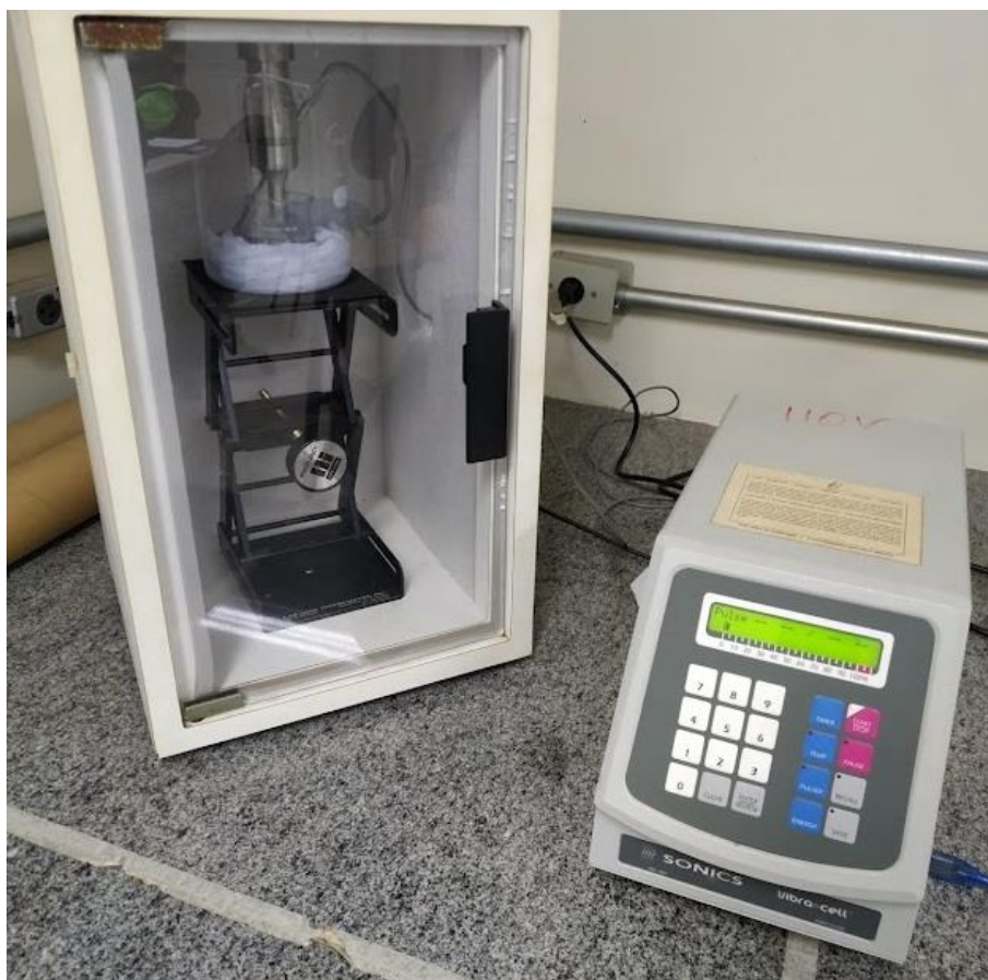
Figura 10 - Procedimento de redução de tamanho das partículas CALC por processo sonoquímico.
