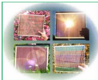
Figura 28. Célula fotovoltaica sensibilizada por corante
