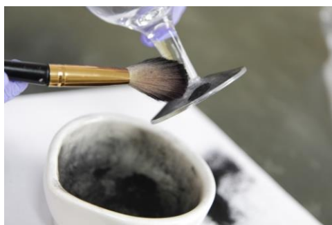
Figura 7- Aplicação do pó de carvão sobre a impressão digital oculta
