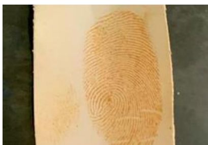
Figura 9- Impressão digital revelada pela técnica do vapor de iodo Fonte: as autoras.
