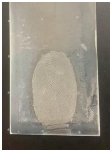
Figura 13- Impressão digital revelada utilizando cianoacrilato Fonte: as autoras
