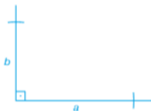
Figura 24 – Construção do ângulo reto
