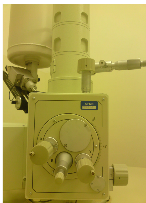
Figura 10 – Coluna óptico-eletrônica, detector e câmara de amostras.
