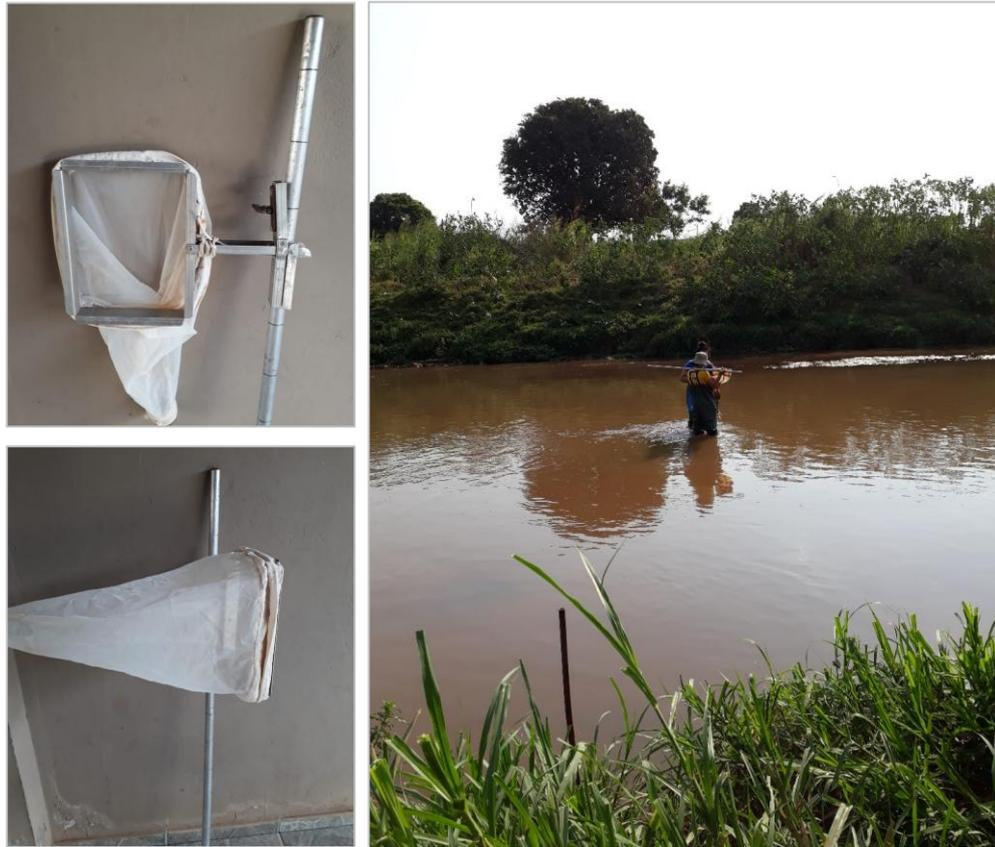
**Figura 2.** Rede de coleta acoplada ao bocal e foto da coleta na seção de amostragem.
