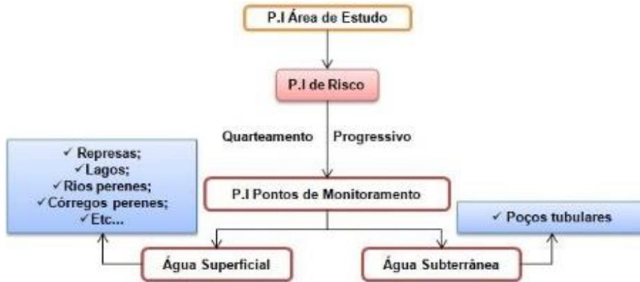
Figura 3 Fluxograma para delimitação de áreas prioritárias para instalação de pontos de monitoramento da qualidade das águas, superficial e subterrânea, baseado-se nos maiores percentuais de risco intrínseco à contaminação por pesticidas das áreas progressivamente quarteadas.
