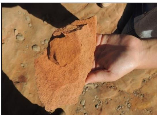
Figura 2F) Arenito quartzoso de granulometria fina, bem selecionado, com grãos arredondados, intemperizado de cor ocre. (Fonte: CARVALHO, 2018)
