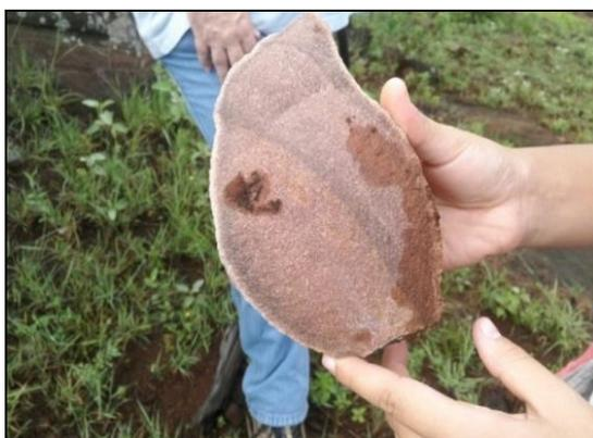
Figura 2G) Arenito quartzoso pouco feldspático, bem selecionado de granulometria grossa, bem arredondado de coloração rosa avermelhada, concentrando minerais opacos e/ou máficos entre as laminações. (Fonte: CARVALHO, 2018)
