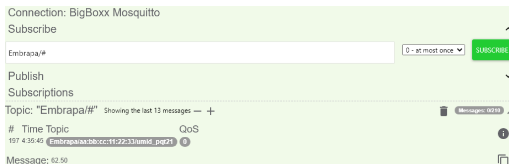
Figura 15 – Publicação por MQTT de leitura de umidade relativa do ar realizada por um dispositivo com mac-address aa:bb:cc:11:22:33 da propriedade Embrapa .
